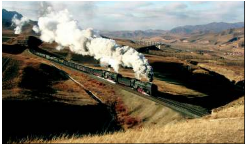
Auf dem Weg zum Jing-Peng-Pass: Damit die Lok den Anstieg schafft, werden gleich zwei QJ hintereinander vor den Zug gespannt. Das Ergebnis sind 6000 PS Zugkraft.
